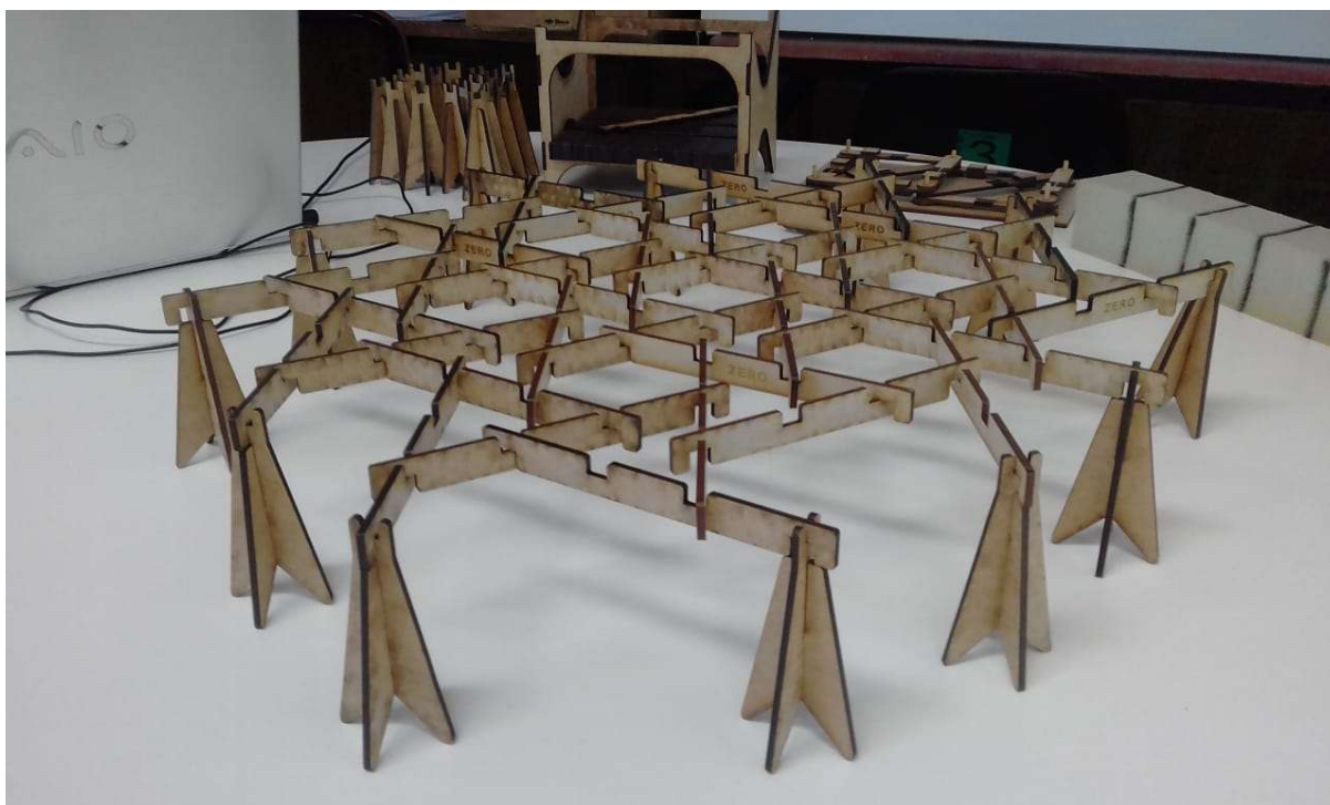
Imagem: Modelo de vigas recíprocas. Autoria: LCC, 2019.
