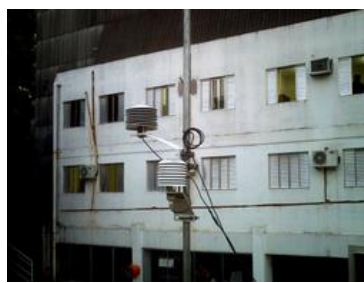
Sensores Digitais do Pluviômetro Digital SAISP Foto dos Autores
