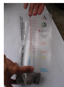
Pluviômetro de garrafa Pet Foto CAPR
